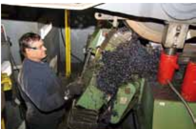
Předě dvěma lety v Ostravě výrazně upravili i podúrovňový soustruh.
