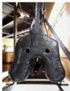
Obrovské kladky zajišťují pevné spojení vozu a polytetrafluorethylenu ocelového lana.
