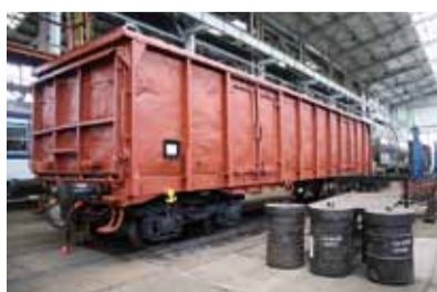
Součástí revizních oprav je i obnovení vnějšího nátěru vozu.
