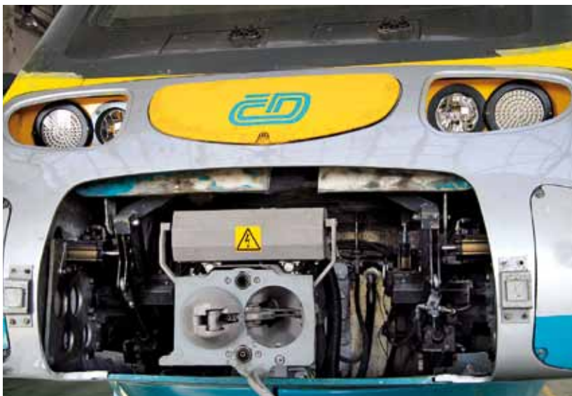
VÝMĚNA. Pro sestavu světel bylo nakonec přistoupeno i k výrobě celého nového držáku ve Studénce. Inovace proběhne do konce roku u všech Pendolin.
