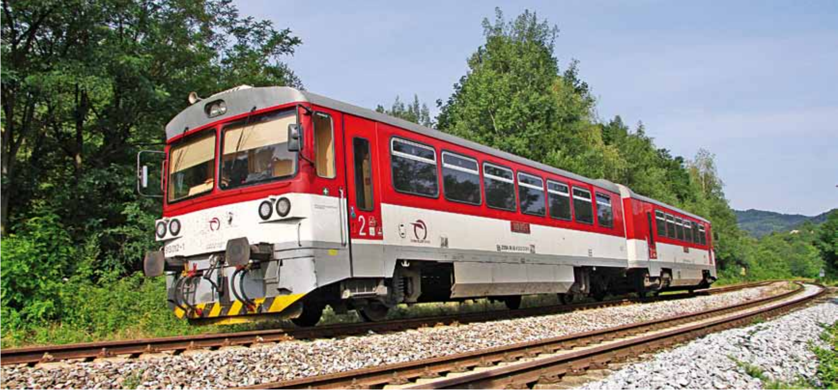
BAGETA. Také slovenský národní dopravce se vydal cestou radikální modernizace starších motorových vozů řady 810. Zde v trochu tišším provedení. FOTO AUTOR (2x)
