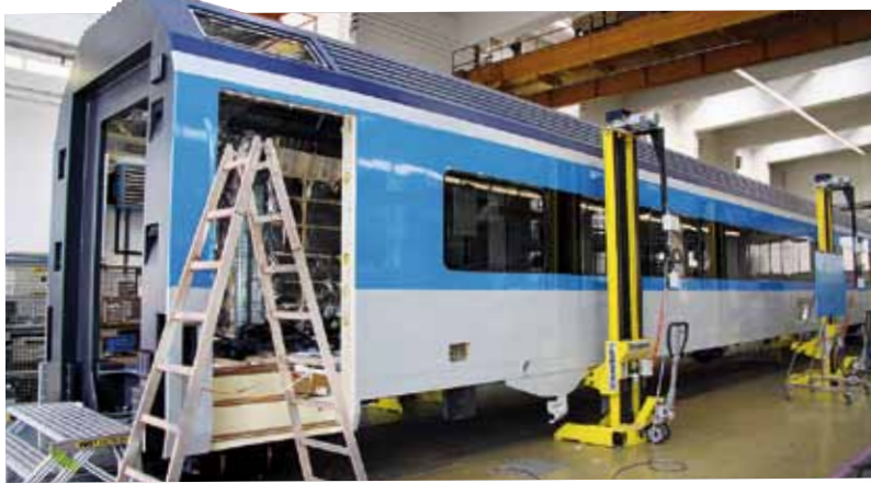
Vůz po lakování do barev ČD čeká na kompletaci interiéru.
