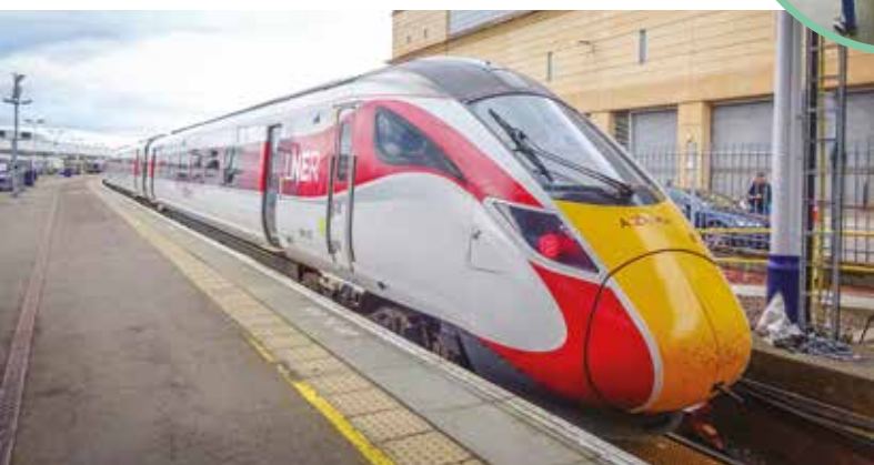
Na dálkové vlaky z Londýna je nasazována jednotka Azuma. Může využít jak vrchní elektrické napájení, tak pět dieselových motorů.
