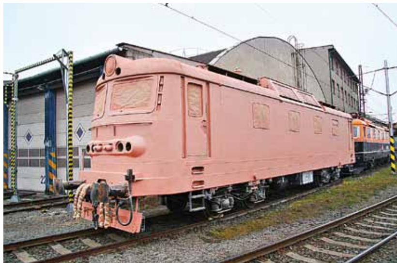
PŘED DOKONČENÍM. Lokomotiva právě čeká na nástřik vrchním lakem.
