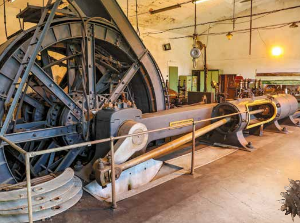
Největší chloubou je bezesporu původní parní těžní stroj z roku 1891.
