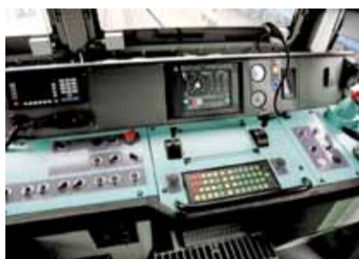
Všechny informace o stavech a provozu lokomotivy předává LCD displej.
