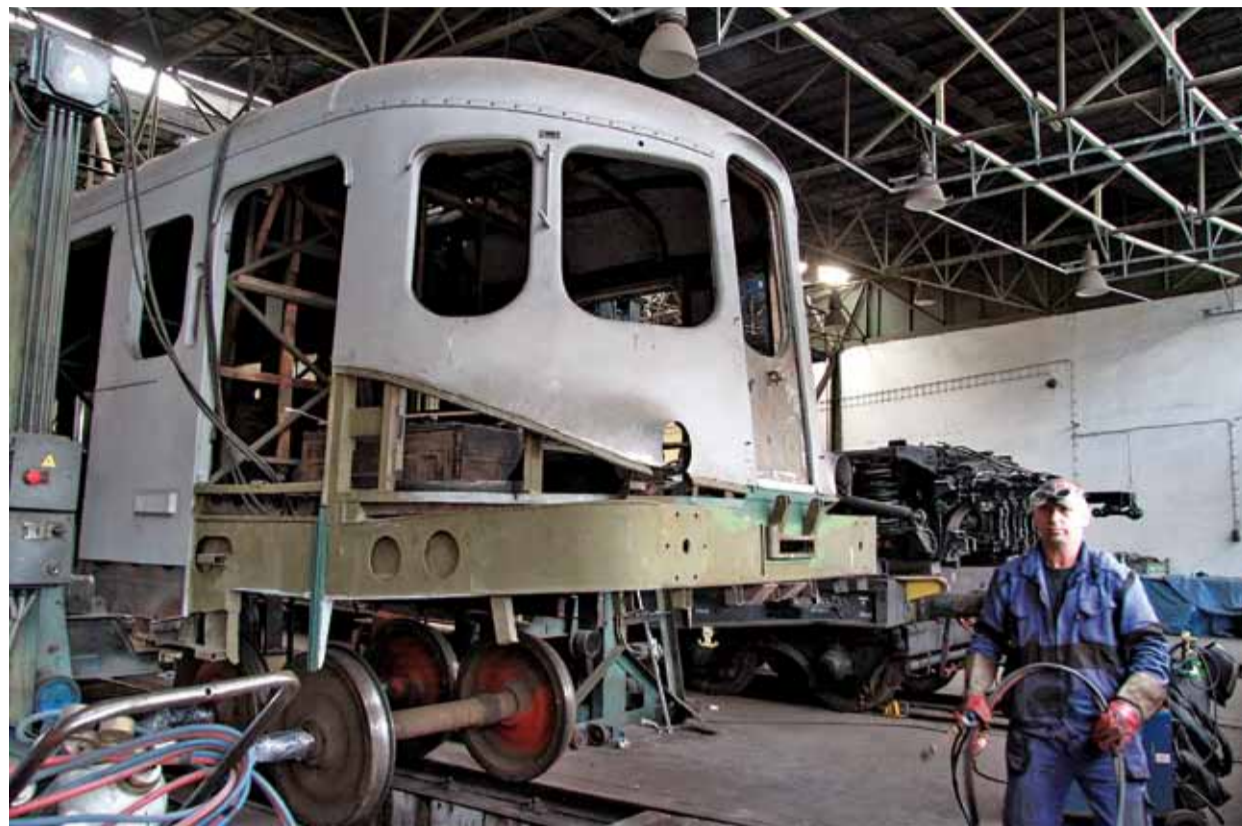
OŽIVOVÁNÍ. Stříbrný šíp dostává v Nymburce kompletně nový interiér, většinu pohonu a ovládání.
