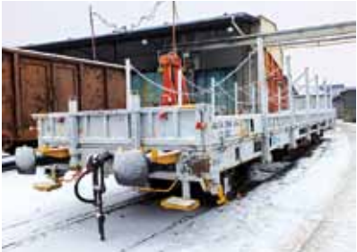
K tradičním opravám patří revize plošinových vozů řady Res. FOTO AUTOR
