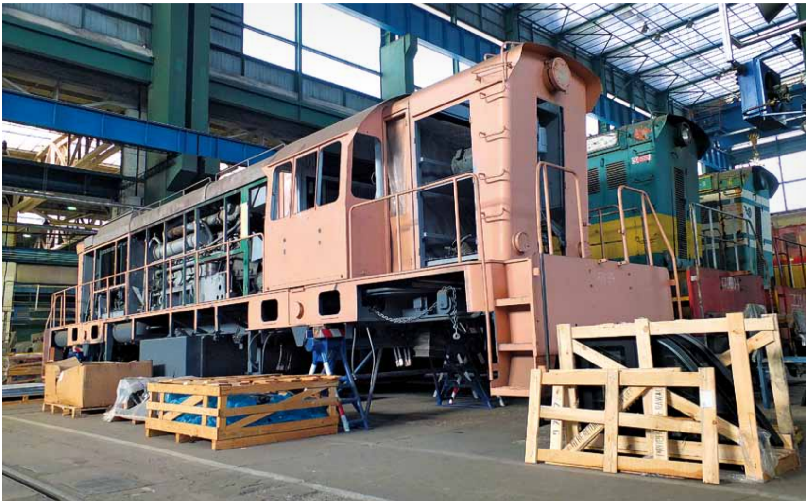
VZKRŠIŠENÍ. Ve Vrútkách dokážou opravit jak moderní, tak starší kolejová vozidla. Na novou podobu zde například čekají Čmeláci řady 771.
