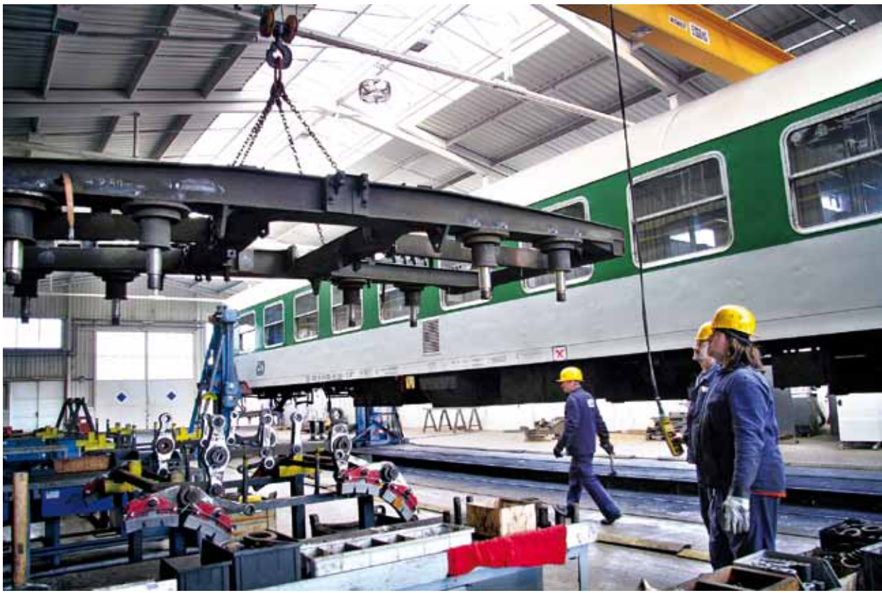
ODBORNÝ PROCES. Specifikem olomouckého depa je zaměření na podvozky rozšířených rychlíkových vozů.
