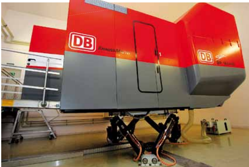
NA MUŘI NOŽCE. Podivná konstrukce připomínající příbytek baby jagy v sobě skrývá sofistikovaný trenažér pro strojvedoucí. Slouží od roku 1997.
