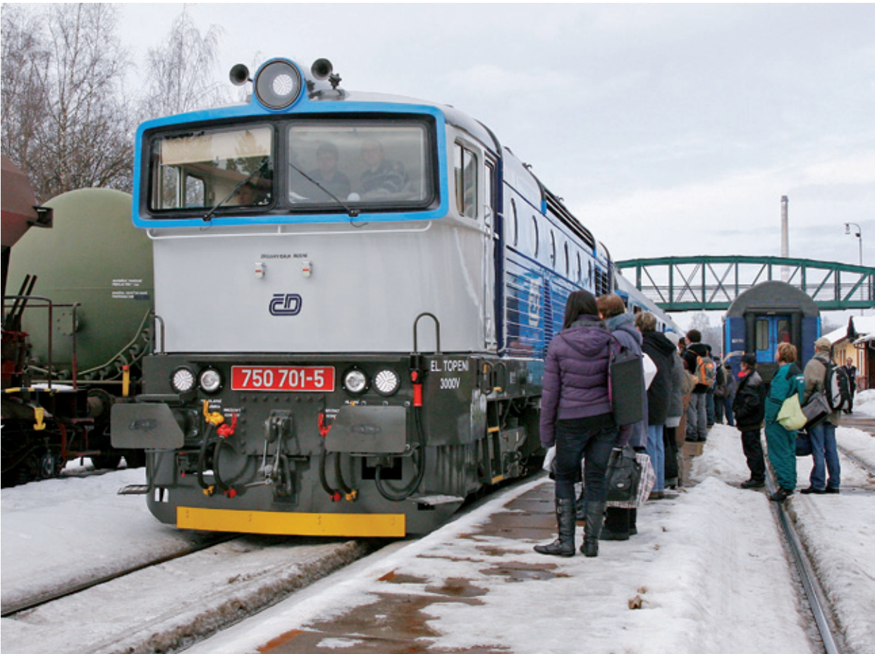
Modernizace je jednou z cest, jak omladit vozidlový park. Jedním ze zástupců znovuzrozených strojů je Brejlovec řady 750.7, který pod svým klasickým vzhledem ukrývá v podstatě novou lokomotivu.
